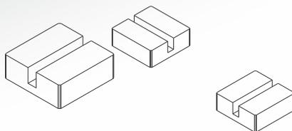
UNSER HOCHWERTIGE ENDSTEIN IST 40X40 MM UND AUS 10 MM ALUMINIUM GEFERTIGT, GESTRAHLT UND ELOXIERT, GEEIGNET FÜR EINE 5-6 MM STARKE PLEXIGLASSCHEIBE. ANFERTIGUNG NACH KUNDENWUNSCH MÖGLICH.
